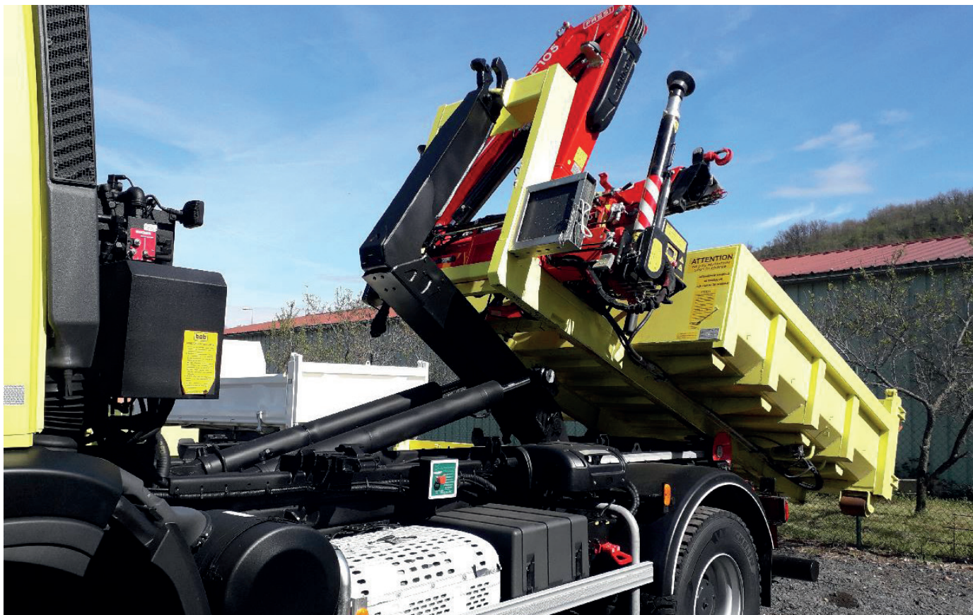
Camion CG156 équipé d'un bras benne amovible, d'une saleuse et d'une lame bi-raclage convertible en étrave mis en service pour la saison 2023-2024.
