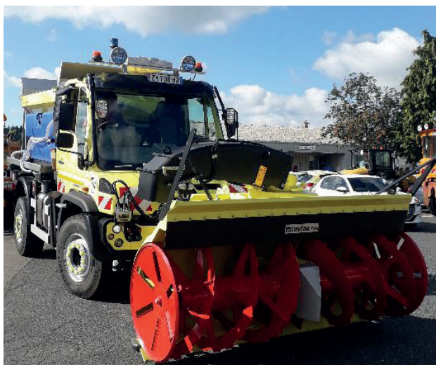
Porteur Mercedes UNIMOG type UGE 530 avec saleuse à tapis STRATOS, son étrave transformable et sa turbo-fraise mis en service pour la saison 2022-2023.
