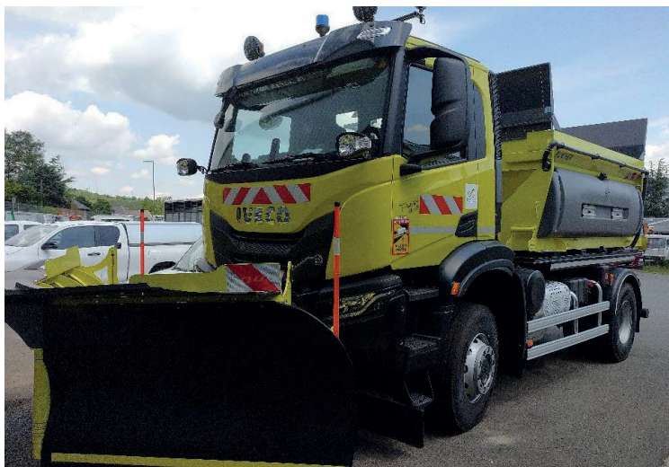
CG154 IVECO TRAKKER AD190 équipé d'une saleuse à chaîne mixte et d'une lame bi-raclage convertible en étrave mis en service pour la saison 2023-2024.
